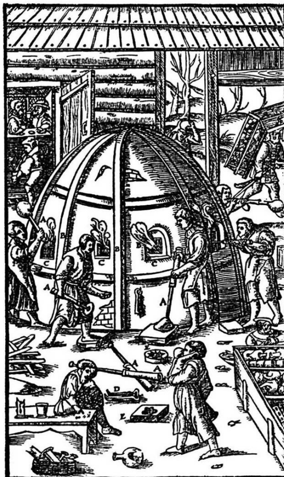
A: Tubo para soplar.—B: Abertura pequeña.—C. Marco.—D. Tenaza.—E: Mol- des para dar forma al vidrio
